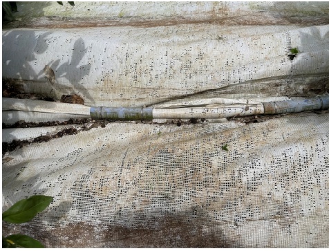
写真1 シトラスシートの被覆1年後の劣化状況（令和5年7月）
