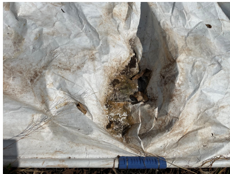
写真3 タイベックシート（スーパーソフト）の被覆1年後の劣化状況 （令和5年8月）
