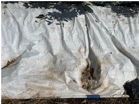
写真3 タイベックシート（スーパーソフト）の被覆1年後の劣化状況 （令和5年8月）
