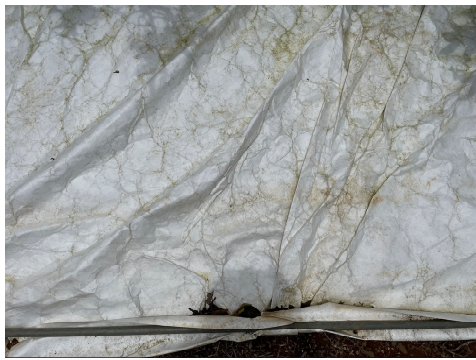
写真2 タイベックシート（ハード）の被覆1年後の劣化状況（令和5年7月）
