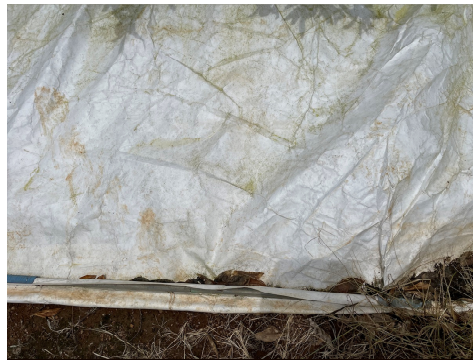
写真2 タイベックシート（ハード）の被覆1年後の劣化状況（令和5年7月）
