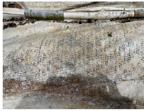
写真1 シトラスシートの被覆1年後の劣化状況（令和5年7月）
