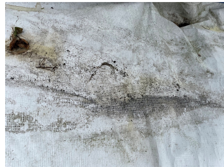
写真 1 シトラスシート (3 層) の被覆期間中の劣化状況 (令和 5 年 10 月) シート設置 : 令和 5 年 1 月下旬、マルチ被覆 : 令和 5 年 8 月 7 日
