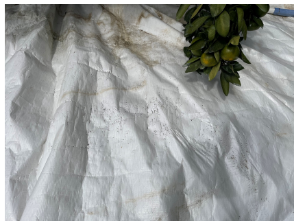
写真3 シトラスシート(3層)の被覆期間中の劣化状況(令和5年10月) (シート設置:令和5年1月下旬、マルチ被覆:令和5年7月20日)
