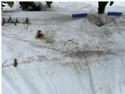
写真 1 シトラスシート (3 層) の被覆期間中の劣化状況 (令和 5 年 10 月) シート設置 : 令和 5 年 1 月下旬、マルチ被覆 : 令和 5 年 8 月 7 日
