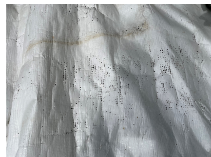
写真3 シトラスシート(3層)の被覆期間中の劣化状況(令和5年10月) (シート設置:令和5年1月下旬、マルチ被覆:令和5年7月20日)
